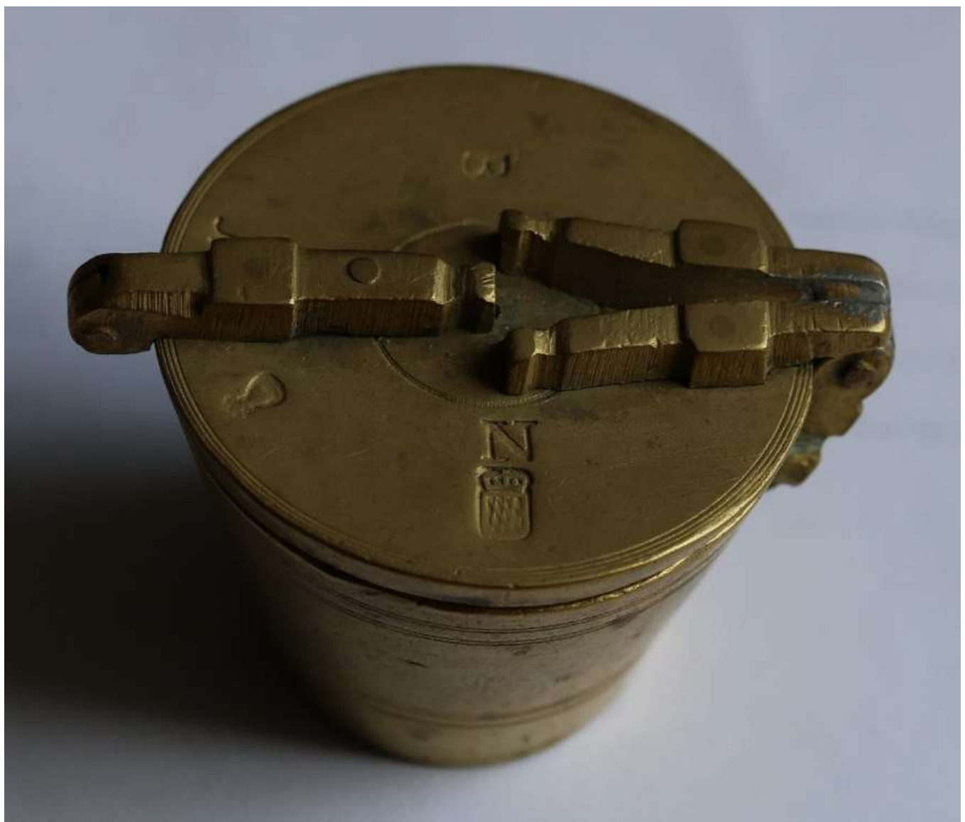
Ein sogenanntes Einsatzgewicht (ineinander gestapelte Napfgewichte) mit ganz besonderer Prägung: N und das Wappen von Nürnberg sagen aus, dass es in Nürnberg gefertigt wurde – und der Kelch links daneben weist auf den Hersteller hin: ein Erasmus Fleischmann in Nürnberg hat 1727 diesen Stempel verwendet! So können Gegenstände zum Reden gebracht werden! Unser Experte Frank Junge kann noch ganz viele solche Geschichten erzählen. Demnächst geht es weiter!
